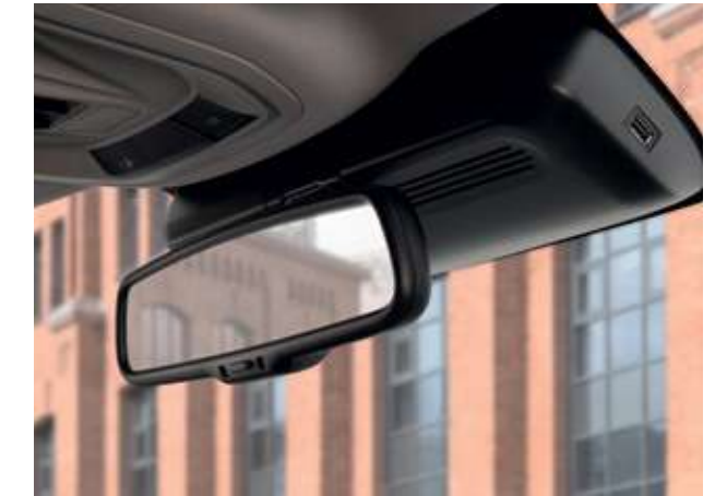
Зеркало заднего вида с автоматическим затемнением и разъемом USB для видеорегистратора
